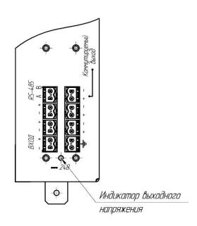
«+ –» – разъемы подключения преобразованного напряжения постоянного тока 24 В.
