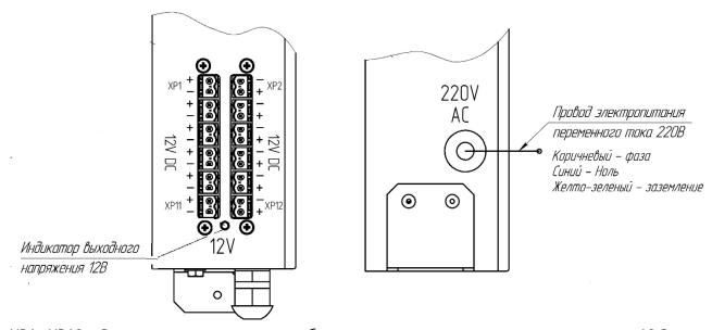
XP1...XP12 – Разъемы подключения преобразованного напряжения постоянного тока 12 В
