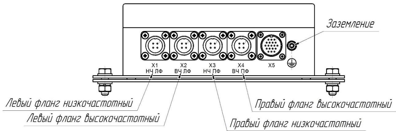
X1–X4 – разъемы для подключения чувствительных элементов
