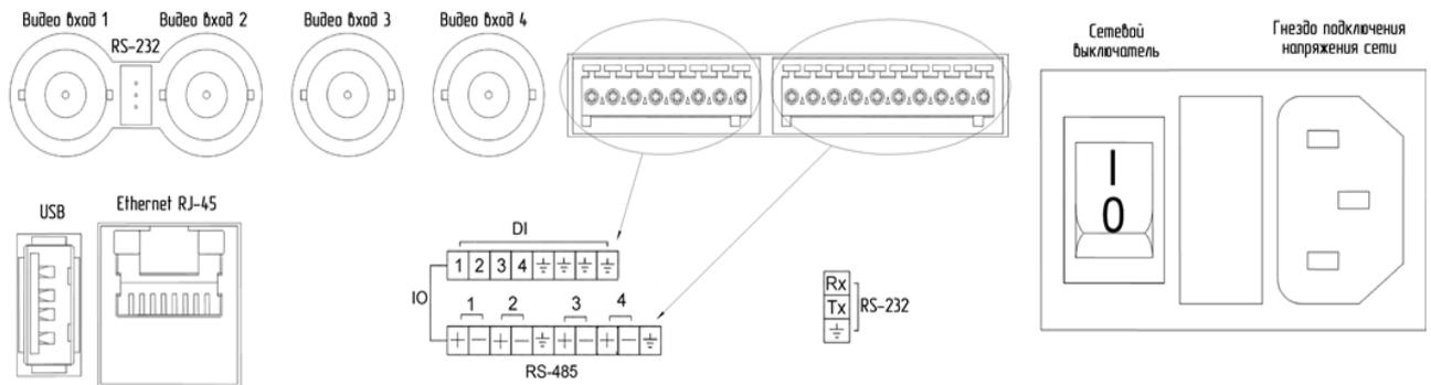
Видео вход 1...Видео вход 4 – разъемы (видеовходы) для подключения видеокамер
