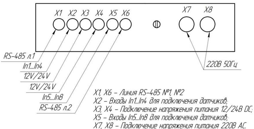
Рисунок 2 – Назначение кабельных вводов на панели контроллера СТС-430
